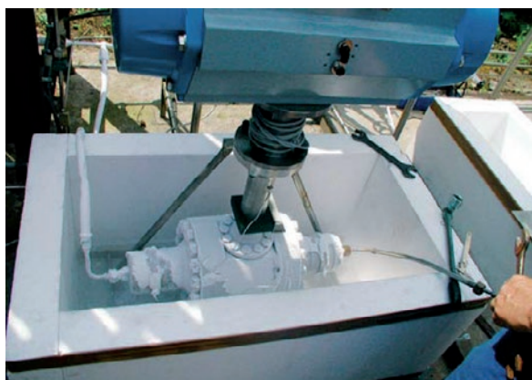
Kryogenische Prüfung – Kugelhahn NPS 4 Class 600
