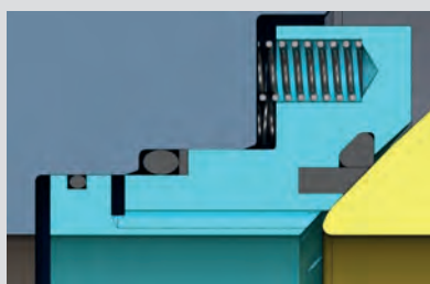
Abb. 3a Sitz PMSW mit Elastomer und Thermoplast
